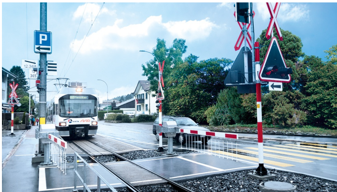
Bağlık: PSS 4000-R otomasyon sistemi demiryolu geçişlerini (bariyer koruması olan ve olmayan) emniyet altına almak üzere Avrupa'da kullanılmaktadır ve kontrol ile emniyet görevlerini üstlenir.
