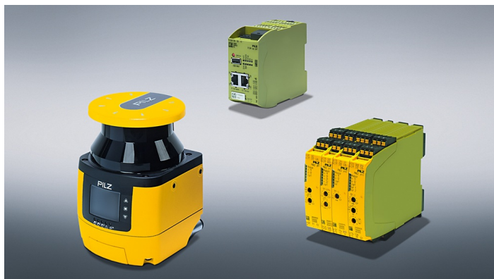
Bildtext: I Pilz helhetslösning ingår den säkra laserskannern PSENscan (kollisionsskydd för människor och FTS), det expanderbara säkerhetsreläet myPNOZ respektive den konfigurerbare ministyrningen PNOZmulti 2 (som utvärderingsenhet) samt Industrial Firewall SecurityBridge (manipulationsskydd). (Foto: © Pilz GmbH & Co.KG)
