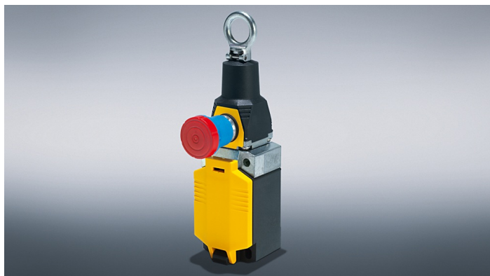
Bildtext: Med sin 30 meter långa lina är linbrytaren PSENrope mini från Pilz ett pålitligt och kostnadseffektivt nödstopp för långa transportband, t.ex. i förpackningsindustrin. (Foto: Pilz GmbH & Co. KG)
