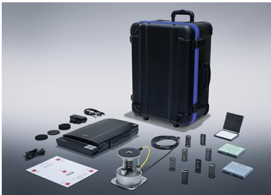
**Legenda:** O novo sistema de medição de força e de pressão PROBms da Pilz tem como objetivo a comprovação da concordância das exigências de segurança com as normas vigentes para a MRK, no presente caso, conforme a ISO/TS 15066.
