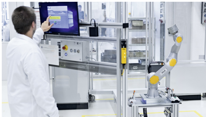
キャプション: ピルツのオートメーションソリューションが設備や機械を保護: 権限のある従業員のみアクセスを許可し、外部からの不正操作を防止します。(写真: Pilz GmbH & Co. KG)
