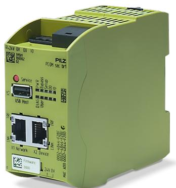
**Didascalia:** Protezione completa per reti di automazione industriali: il firewall SecurityBridge consente fin da subito la comunicazione dati con ulteriori nodi di rete che non rientrano nella famiglia di prodotti Pilz. (Foto: Pilz GmbH & Co. KG)
