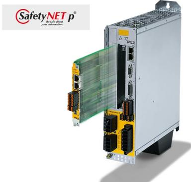
**Légende:** La nouvelle carte de sécurité PMCprotego S3 de Pilz complète la solution Safe Motion intégrée dans le variateur par de nouvelles fonctions Motion Monitoring de sécurité selon l'EN 61800-5-2. Grâce à ces fonctions, il est désormais possible de configurer au préalable une réponse aux erreurs spécifique à l'application de manière flexible et personnalisée via le logiciel d'ingénierie PASmotion. Cela permet de réduire les arrêts de machines. (Photo : © Pilz GmbH & Co.KG)
