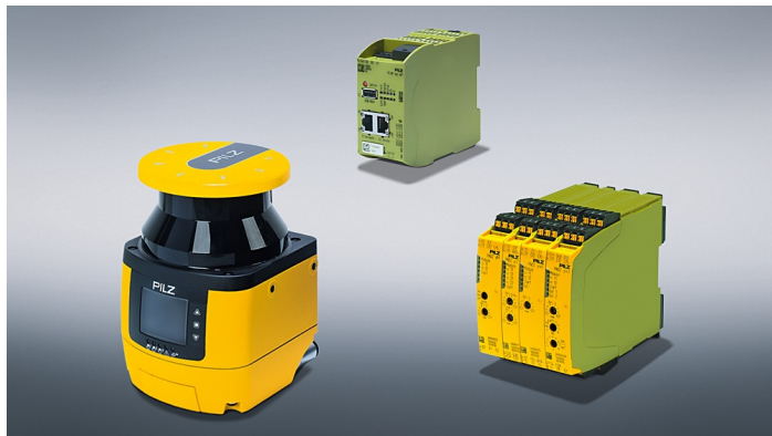
Bildunterschrift: Zur Pilz Komplettlösung gehören der Sicherheitslaserscanner PSENscan (Kollisionschutz von Mensch und FTS), das modulare Sicherheitsrelais myPNOZ bzw. die konfigurierbare Kleinsteuerung PNOZmulti 2 (als Auswerteeinheiten) sowie die Industrial Firewall SecurityBridge (Manipulationsschutz). (Foto: © Pilz GmbH & Co.KG)
