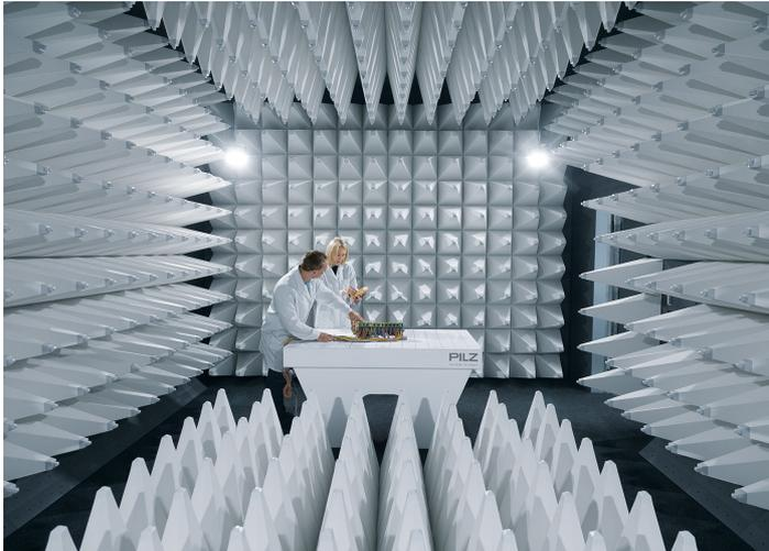
**Bildunterschrift:** Am Stammsitz Ostfildern baut Pilz seine Forschungs- und Entwicklungsaktivitäten weiter aus. In den neuen Laborbereichen stehen zum Beispiel umfangreiche Test- und Prüfmöglichkeiten zu Verfügung, darunter ein akkreditiertes EMV-Labor für elektromagnetische Verträglichkeit.
