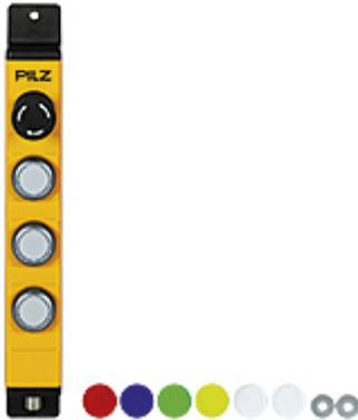
PITgatebox (кнопочный блок), собранный корпус с элементами управления и кнопкой аварийного останова, шириной 40 мм, коробка с кнопкой аварийного останова (2 НЗ) и 3 кнопками с подсветкой (1 НР каждая), подключение с помощью 12-контактного разъема M12, IP65, с цветными крышками цветов ЗЛ, СН, КР, ЖЛ, также имеется прозрачный вариант
