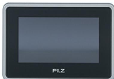
PMIvisu, диагностический рабочий терминал, 4,3", разрешение 480 x 272 пикселей, емкостный сенсорный экран, TFT, ОЗУ 512 МБ, флэш-память 2 ГБ, 1 порт RJ45 на 100 Мбит/с, 1 основной порт USB 2.0, часы реального времени с подпиткой от конденсатора, 24 В пост. тока, 4 Вт, экономичная версия, ОС Linux, установленная система PASvisu Runtime лицензией, предустановленное ПО: ПО визуализации Pilz.
