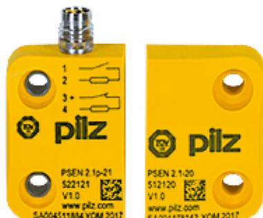
Магнитный защитный датчик 1 н/р 1 н/з, 4-контактный штекер M8 синдикатором, квадратный, IP67, расстояние срабатывания 8 мм, высота 13 мм, PU = объединен с исполнительным механизмом.
