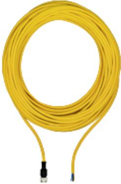
Cabo de ligação, PUR, amarelo RAL1003, blindado, 4 polos, plugue reto M12, na extremidade do cabo aberta, codificação A, comprimento do cabo:10m
