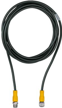
Cabo de conexão, conector M12 de 5 pinos, reto, codificado A no conector M12 de 5 pinos, reto, codificado A, seção transversal do condutor: 5 x 0,34 mm<sup>2</sup>, comprimento do cabo: 5 m
