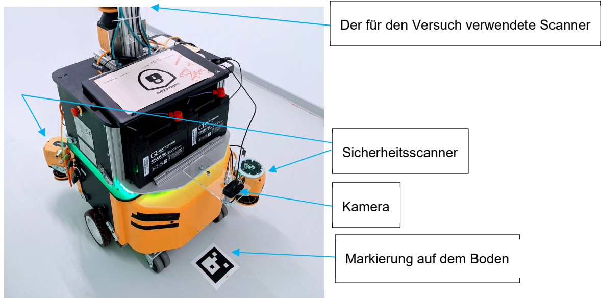
Abbildung 6: Der AMR transportiert mehrere Scanner mit unterschiedlichen Aufgaben sowie die Kamera zur Erkennung von Markierungen
