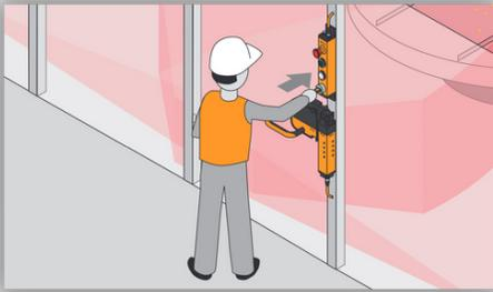
Para acceder a la instalación, el operador se autentica con su llave transpondedor personal en el PITreader montado en la puerta protectora.
