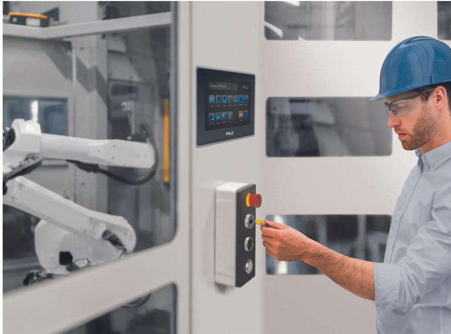
Esta solución garantiza que no será posible poner en marcha una máquina mientras haya personal en la zona de peligro. La protección para el mantenimiento "Key-in-pocket" está concebida para máquinas con zonas peligrosas con una valla de protección y a la que ha de acceder el personal, p. ej., células de robotización.
