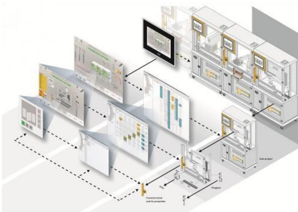
Figura 4: Le linee automatiche possono essere suddivise in unità monitorabili ed autonome.
