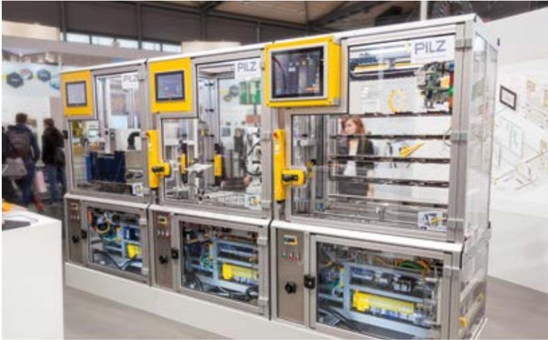
미래 자동화는 제어 정보를 배포하면서도 사용이 손쉬운 솔루션을 요구합니다. 자동화 시스템 PSS 4000이라면 가능합니다. 허가권이 동일한 다수의 컨트롤러를 실시간 이더넷 Ethernet SafetyNET p를 통해 간단히 연결합니다. SafetyNET p는 컨트롤러 간 데이터와 상태 정보를 교환하고 이를 동기화합니다.
