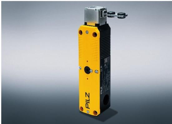
Legenda: Não importa se o monitoramento seguro da porta de proteção é realizado com ou sem bloqueio, ambos podem ser implementados com o PSENmech da Pilz: como relé de segurança mecânica, ele permite o travamento puro da porta de proteção, como sistema de porta de proteção mecânica, é complementado por um bloqueio.
