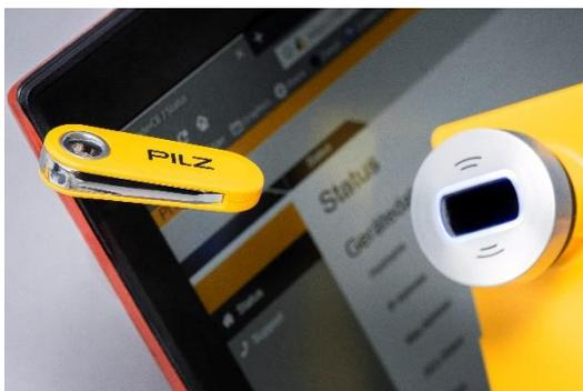
Pie de foto: Las llaves transpondedor RFID se cargan y programan en el PITreader. La asignación de las autorizaciones de acceso y la selección de los modos de funcionamiento tiene lugar a través del servidor web asociado.
