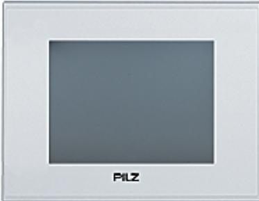
PMIopen, 운영자 조작반, 3.5", 해상도 320 x 240 픽셀, 아날로그 저항막식 터치스크린, TFT, RAM 256MB, 플래시 512MB, SD 카드, 1x D-sub 커넥터 RS232 9핀, 1x RJ45 포트 100MBit/초, 1x USB 슬레이브, 2x USB 호스트, 배터리 버퍼형 실시간 클럭, 24V DC, 6.5W 모든 일반 시각화 소프트웨어용 개방 HMI 플랫폼, PMI Assistant를 통해 구성가능.
