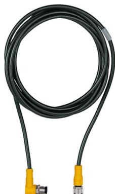
接続ケーブル、5ピンM12オスコネクタ、アングル、Aコード化、5ピンM12メスコネクタ、ストレート、Aコード化、導体接続線径：5x 0.34 mm<sup>2</sup>、ケーブル長：3 m
