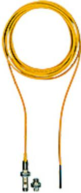
可動ガードの位置監視用安全センサ (EN 60947-5-3適合)、N/O接点2点、N/O補助接点1点、LED、5 mケーブル付き、SIL 3/PL e/Cat. 4までのアプリケーションに対応、円筒形 M12、IP69、PU = センサ×1、M12コード化アクチュエータ、作動距離8 mm、ステンレス製ハウジング。
