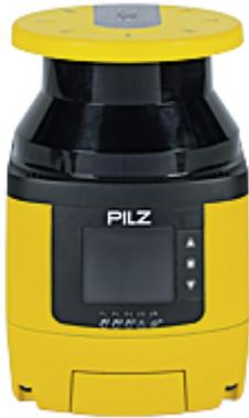
スレーブモデル、30 mm/40 mm/50 mm/70 mm/150 mmの検出機能、垂直アプリケーション、基準マーカ、交換可能なメモリブロックによる高速交換、3.0 m安全ゾーン、PSENscan M 装置使用、最大2個の安全ゾーンを同時に監視、最大10個のコンフィグレーション可能ゾーンセット、測定データ出力(UDP)、ミューティング、オーバーライド、EDM、EN ISO 61496-3に準拠したアプリケーションの再起動。
