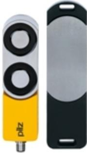
SIL3/PL e/Cat4までのアプリケーションに対応する磁気安全扉システム、磁気保持力1000N (プロセス保護)、コーディング: 特定、完全コード化、5ピンM12コネクタ、LED4個、IP67、包装内容= センサ (スタンダードアクチュエータ付属)
