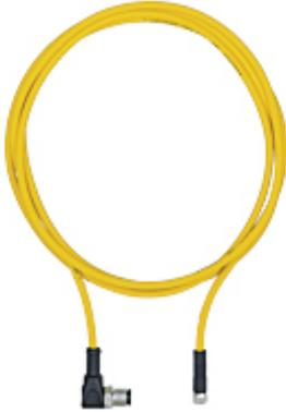
Cavo di connessione, PUR, giallo RAL1003, 4 poli, connettore femminaassiale M8, su connettore maschio angolare M12, codificato A, lunghezza cavo: 2m
