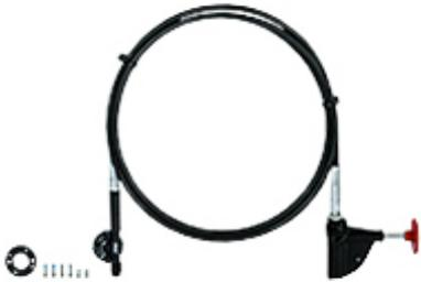
Cavo push-pull sblocco di fuga per il sistema per ripari mobili PSENmlock, lunghezza cavo 0,5m, Contenuto confezione = cavo push-pull ed elemento di azionamento. Con questa variante assicurarsi che l'installazione sia il più possibile precisa e diritta. Per gli sblocchi di fuga con n. d'ordine 570466 e 570467, la piegatura del cavo push-pull può ridurne la funzionalità e la vita utile.
