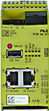
PCOM, SecurityBridge, server VPN per la creazione di un tunnel VPN, supporta certificati X.509, 2 porte RJ45, porta USB, 1 ingresso digitale, 1 uscita digitale, 2 A, unipolare, Module Supply 24 V DC 0,32 A, Periphery Supply 24 V DC 2 A, server Web integrato, supporta autenticazione e comunicazione sicure solo con moduli compatti PNOZmulti (per sistemi PLC utilizzare 'PCOM sec br2').
