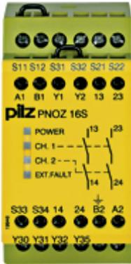
Relè di sicurezza (stand-alone), Ingressi: cablaggio mono/bicanale con/ senza rilevamento del cortocircuito, Uscite: 2 NA, 2 SC, UB = 110 VAC/ 24 V DC, Larghezza: 45 mm, morsetti a vite integrati, controllo di arresto di emergenza, ripari mobili, tappeti di sicurezza (in base a principio di cortocircuito), circuito di retroazione.
