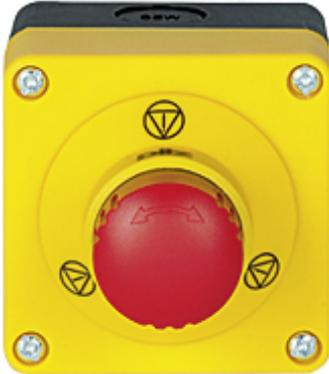
PITestop, arrêt d'urgence / bloc de contacts y compris boîtier demontage, kit composé d'un bouton-poussoir d'arrêt d'urgence avec symbole de l'arrêt d'urgence etlogo et d'un bloc de contacts avec surveillance 2n/f, avec borniers à ressorts.
