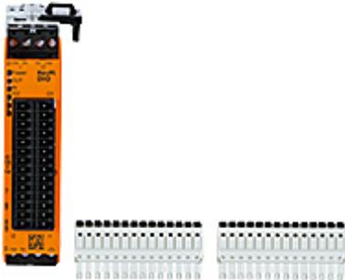
Module d'extension digital DIO pour le support RevPi Core / RevPi Core 3, dimensions du boîtier (H x L x P) : 96 x 22,5 x 110,5 mm, indice de protection : IP 20, nombre d'entrées digitales : 14, nombre de sorties digitales : 14, courant max. par sortie : 500 mA (High-Side Mode), 100 mA (Push-Pull Mode).
