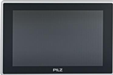
PMIvisu, interface Homme Machine, 12,1", résolution 1 280 x 800 pixels, écran tactile capacitif, TFT, RAM 256 Mo, Flash 512 Mo, carte SD, 1 connecteur SUB D RS232 à 9 broches, 1 port RJ45 100 Mbit/s, 1 esclave USB, 2 maîtres USB, horloge en temps réel sauvegardée par batterie, 24 V DC, 15,2 W, logiciel préinstallé : PASvisu Server, PASvisu Viewer PMI, firmware PSS 4000 (serveur OPC).
