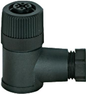
Connecteur, connecteur femelle coudé M12 à 5 broches, codé B, raccordement à vis, matériau de la bague filetée : CuZn nickelé, diamètre extérieur du câble : 4-6mm
