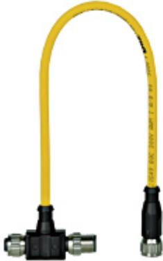
Câble, adaptateur en Y avec connecteur en T, IP67, connecteur mâle M12(X2, unité de contrôle), à 8 broches, codé A sur connecteur femelle M12 (X1, capteur/prochain connecteur), à 8 broches, codé A et connecteur femelle M12 (X3, capteur), noir, droit, à 8 broches, codé A, PUR, 0,25 m, 8× 0,25 mm<sup>2</sup>, jaune, pour le raccordement pour PSENcode etPSENslock.
