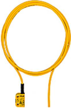
Capteur de sécurité RFID, 2 sorties statiques de sécurité, câble de 5 m, un sens d'activation, supporté par le SDD, IP6K9K, distance de commutation en fonction de l'actionneur, VP = 1 pièce capteur codé sans actionneur.
