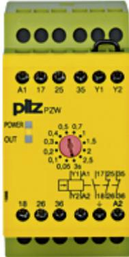
Bloc logique de sécurité (autonome), entrées : câblage monocanal, sorties : 1 F, 2 O, UB = 110 - 120 V AC, largeur : 45 mm, borniers à vis intégrés, relais temporisés à contact de passage, surveillance de laboucle de retour, 12 niveaux de temps de passage de 0,05 à 3 s.
