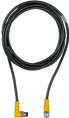
Câble de liaison, connecteur mâle M12 à 5 broches, coudé, codé A sur connecteur femelle M12 à 5 broches, droit, codé A, section du fil : 5 x0,34 mm<sup>2</sup>, longueur du câble : 10 m
