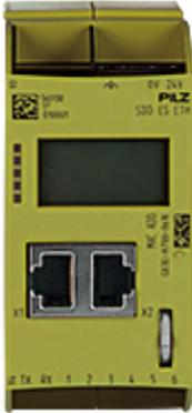
SDD (Safety Device Diagnostics), module de bus de terrain, standard, Modbus/TCP, 2 ports RJ45, 6 entrées / sorties digitales, borniers débrochables (noncompris dans la livraison).
