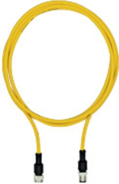
Câble de connexion, PUR, jaune RAL1003, connecteur femelle droit M12 à 5 broches, sur connecteur mâle droit M12, codé A, longueur du câble : 3m
