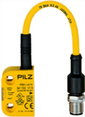
Interruptor de seguridad RFID, 2 salidas por semicond. seguras, conectormacho M12 5 polos, una dirección de accionamiento, IP67, distancia de conmutación según accionador, VP = 1 ud. interruptor encriptado (sin accionador).
