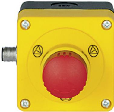
PITestop, parada de emergencia/bloque de contactos con carcasa paramontaje sobre paneles, set compuesto por pulsador de parada de emergencia con símbolo de parada de emergencia, logotipo y bloque de contactos 2 n/c, con conexión M12 5 polos.
