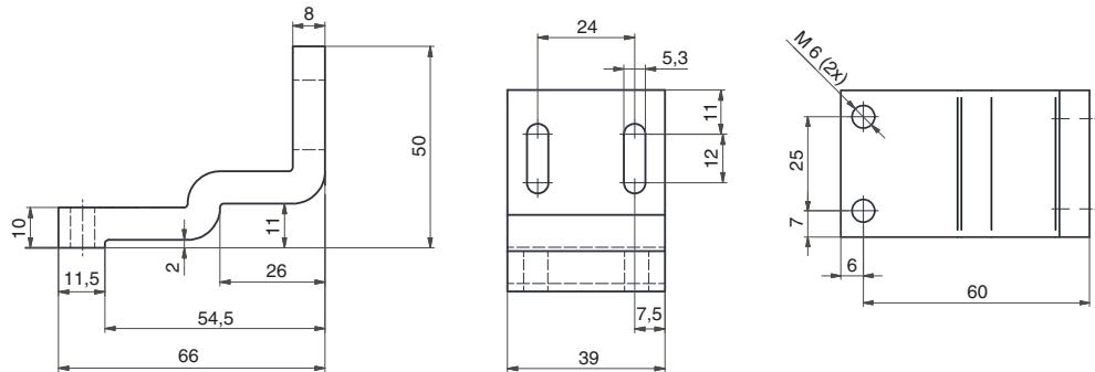
**Montagewinkel Schiebetüre/Mounting bracket sliding gate/Equerre de montage porte coulissante**
