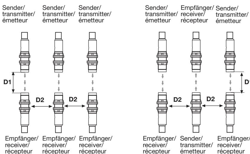
**Mindestabstand: Empfänger auf einer Seite** **Minimum distance: Receivers on one side** **Distance minimale : récepteur d'un côté**
