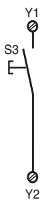
Fig. 8: Rückführkreis mit manuellem Start/Feedback control loop with manual reset/Boucle de retour avec validation manuelle
