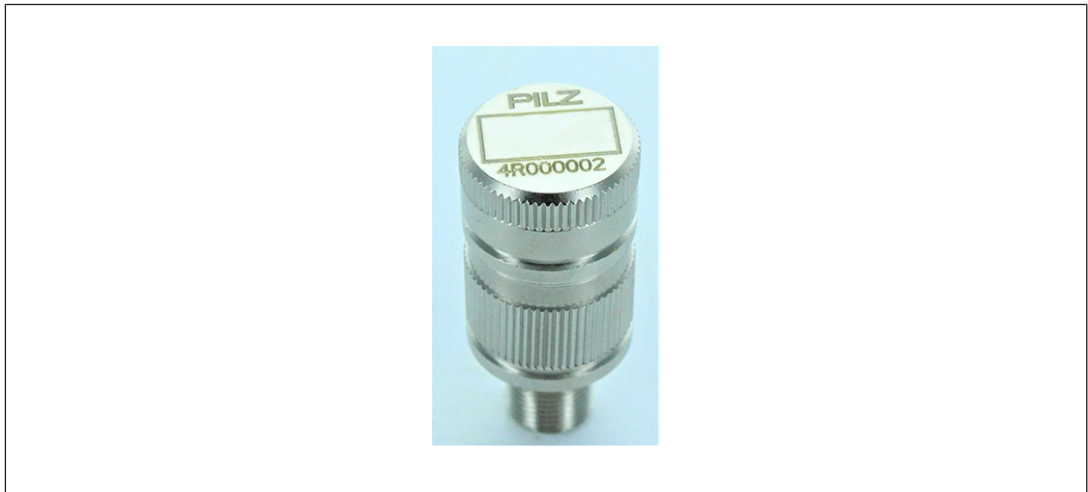
Fig.: Medio de almacenamiento extraíble PDP67
