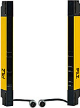
Sicherheitslichtgitter, Typ 4, PL e, Fingerschutz (Auflösung 14 mm), Schutzfeldhöhe 1080 mm. Features: Kaskadierung ohne Totzone, schmale Bauform. Versorgungsspannung 24 V, Anschlussstecker M12, Sender: 5-polig, Empfänger 5-polig. Anschlusskabel nicht im Lieferumfang enthalten.
