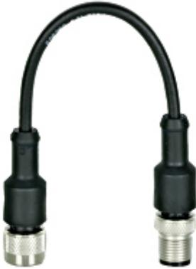
Kabel, Adapter, IP68, M12 Buchsenstecker, schwarz, gerade, 4-polig, A-codiert auf M12 Stiftstecker, schwarz, gewinkelt, 5-polig, A-codiert, PUR, 0,1 m, 3× 0,34 mm<sup>2</sup>, schwarz, zum Anschluss eines Sensors PSEN op1.2 (Lichtschranken) an PSS67 und PDP67.
