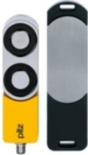
Sicherheitszuhaltung PSENSlock, vollcodiert, mit elektromagnetischer Zuhaltung, mit Sicherheitsschalter und Betätiger (Standard), Zuhaltung für den Prozessschutz, Zuhaltkraft 1000 N, 8-pol. M12-Stiftstecker, Reihenschaltung
