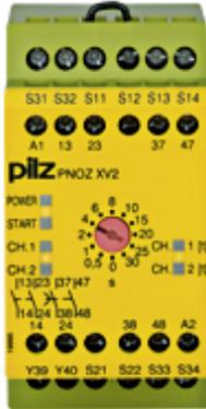
Sicherheitsschaltgerät (standalone), Eingänge: 1/2-kanalige Beschaltung mit/ohne Querschlusserkennung, Ausgänge: 2 S, 2 Sz, UB = 24 V DC, Breite: 45 mm, Schraubklemmen integriert, Überwachung von Not-Halt, Schutztüren, mit 2 rückfallverzögerten Kontakten, Verzögerungszeit einstellbar in 12 Stufen von 0,1 - 30 s.
