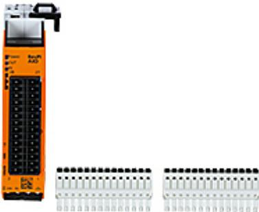
Analoges Erweiterungsmodul AIO für das Basismodul RevPi Core / RevPi Core 3, Gehäuseabmessungen (H x B x T): 96 x 22,5 x 110,5 mm, Schutzart: IP 20, Anzahl der Eingangskanäle: 6, Anzahl der Ausgangskanäle: 2, für Strom, Spannung, RTDs, Ausgangsspannungsbereiche:  $\pm 10$  V,  $\pm 11$  V,  $\pm 5$  V,  $\pm 5,5$  V, 0...10 V, 0...11 V, 0...5 V, 0...5,5 V, Ausgangsstrombereiche: 0...20 mA, 0...24 mA, 4...20 mA.
